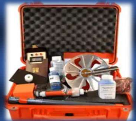
Sistema de mapeo corrosión de concreto
