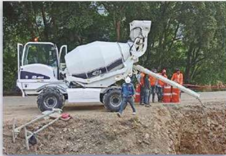
Plantas portátiles para producción de concreto en sitio.
